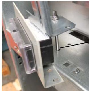
Abb. 3: Halteblech für kapazitive Messstelle (hier mit LR-System) /
