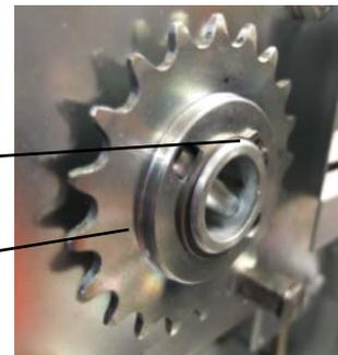
Abb. 6: Antriebswelle mit Kettenrad und Sicherungsring
